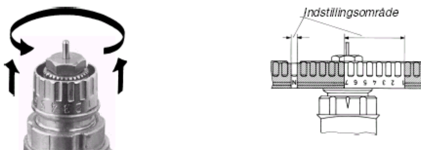
Figur 23. Det er væsentligt, at termostater forindstilles. Det skal ske efter trykprøvning af anlægget, og inden anlægget tages egentligt i brug.
